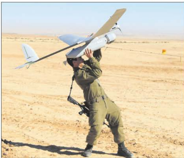
Запуск тактического разведывательного беспилотного летательного аппарата «Скайларк». При боевой массе 5 кг он способен находиться в воздухе непрерывно в течение 90 минут
