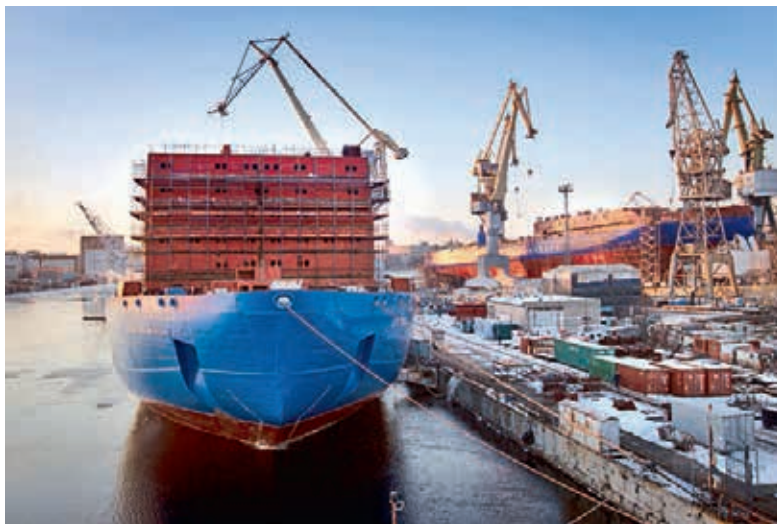
Строительство ледокола «Арктика» проекта 22220 на Балтийском заводе
