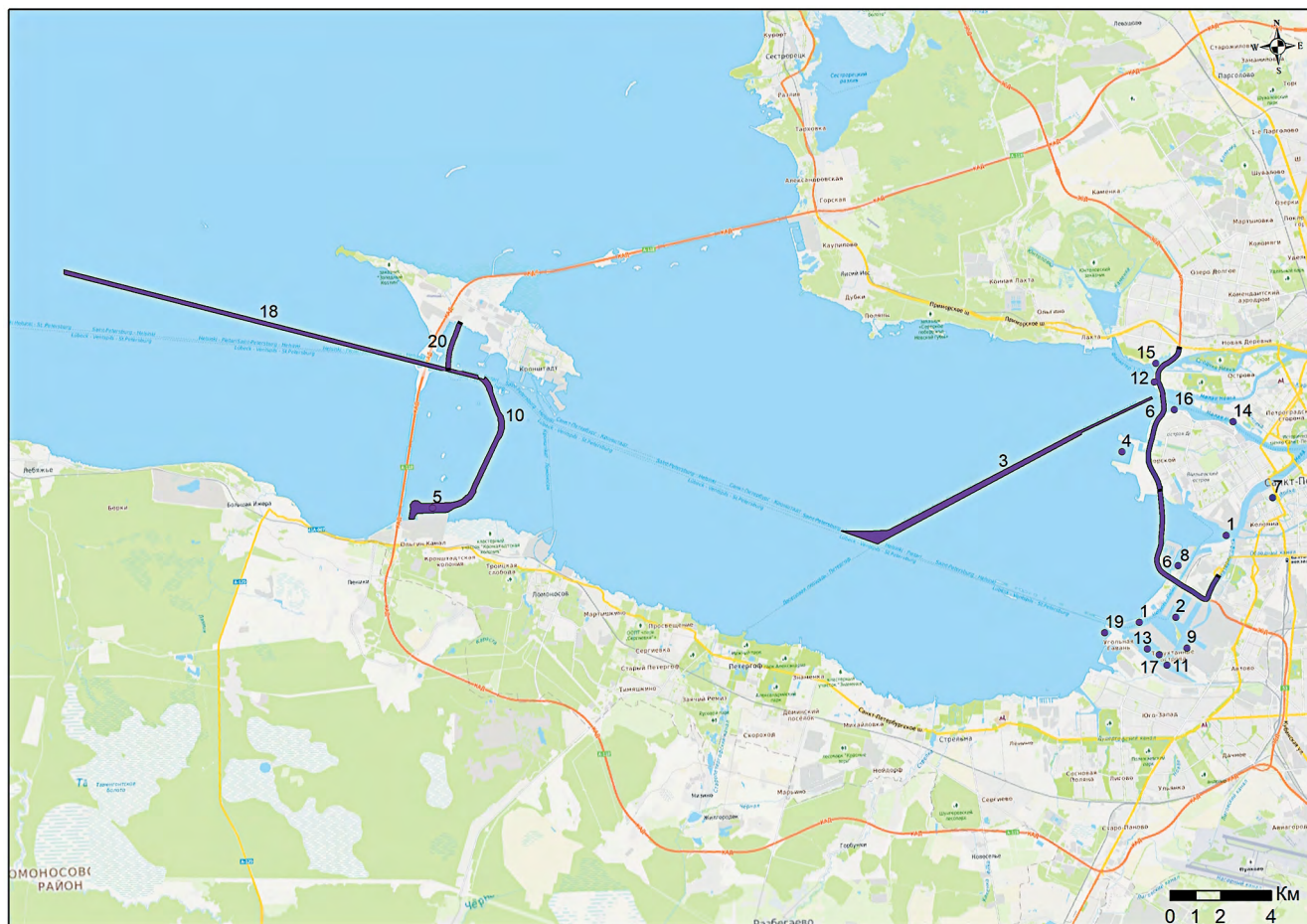
Рис. 2.3. Гидротехнические работы на акватории ВЧФЗ и Невской губы в период 2015–2020 гг. (нумерация объектов здесь и на рис. 2.4–2.5 соответствует перечню ГТР в табл. 2.1).
