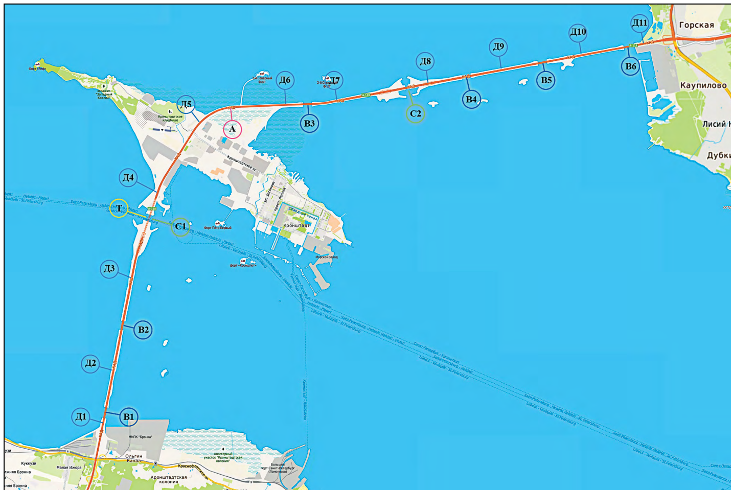
Рис. 2.10. Схема Комплекса защитных сооружений г. Санкт-Петербурга от наводнений.
