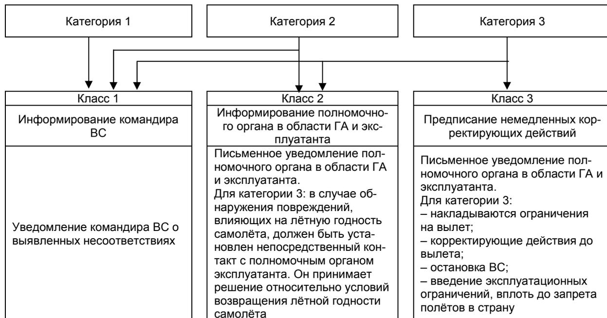
Рис. 2.37. Классы предпринимаемых мер в зависимости от категории опасности выявленного несоответствия
