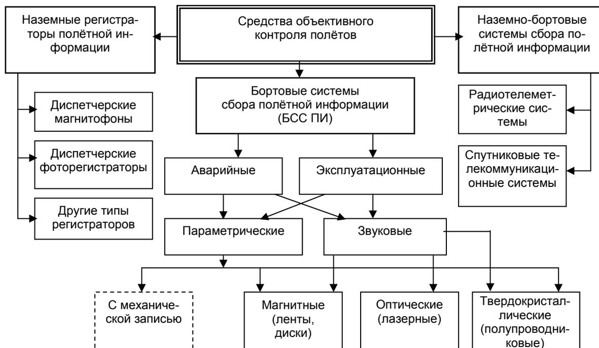
Рис. 2.62. Классификация средств объективного контроля полётов
