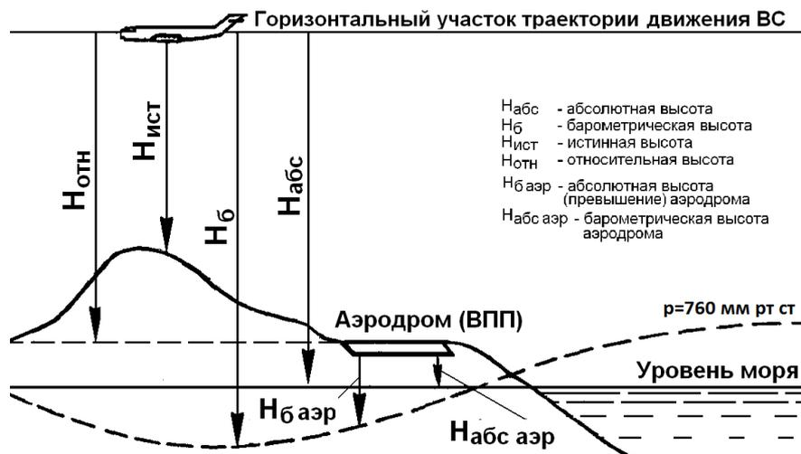
Рис. 1.9. Классификация высот полёта в зависимости от уровня отсчёта высоты
