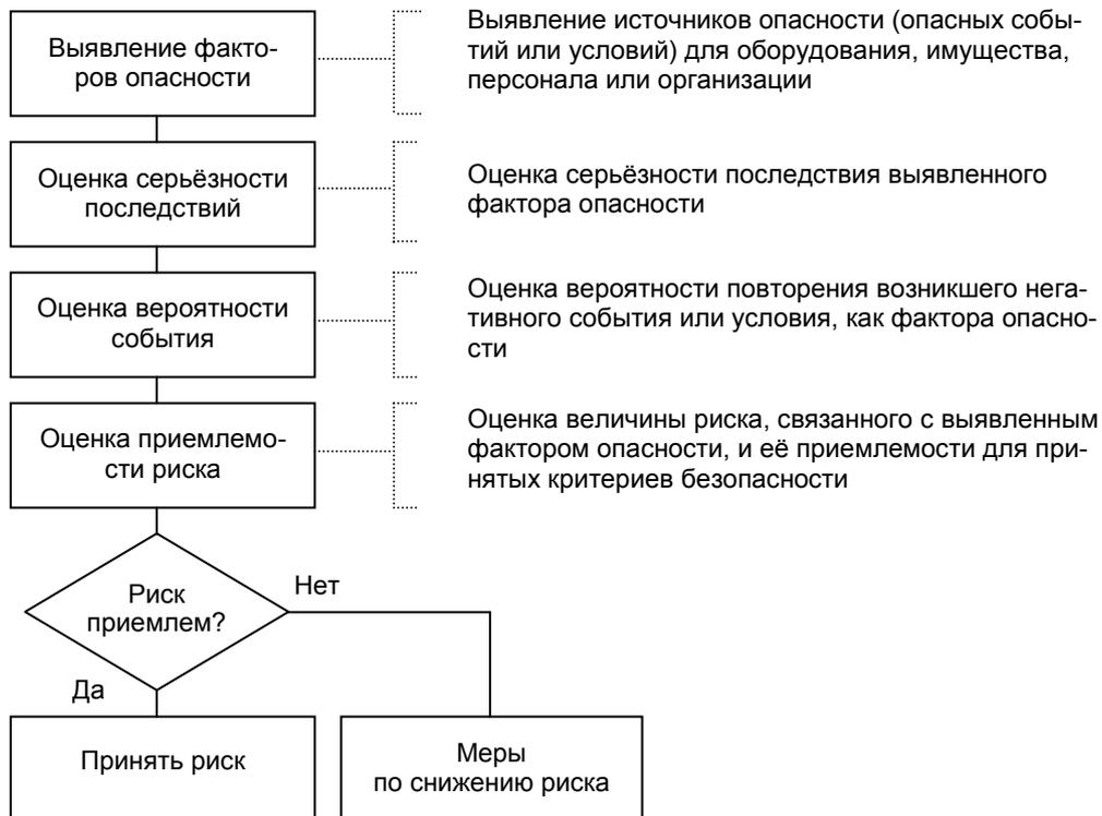
Рис. 2.56. Алгоритм процесса контроля и управления факторами риска
