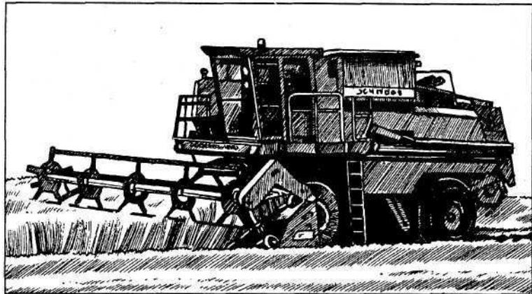
Рис. 32. Комбайн зерноуборочный «Дон-1200 Б»
