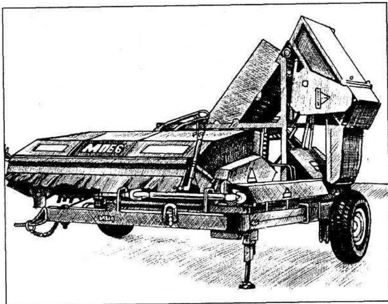
Рис. 41. Машина ботвоуборочная прицепная МБП-6
