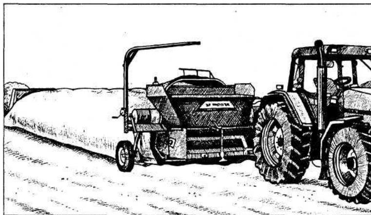
**Рис. 1. Укладка силоса в полиэтиленовый рукав**
