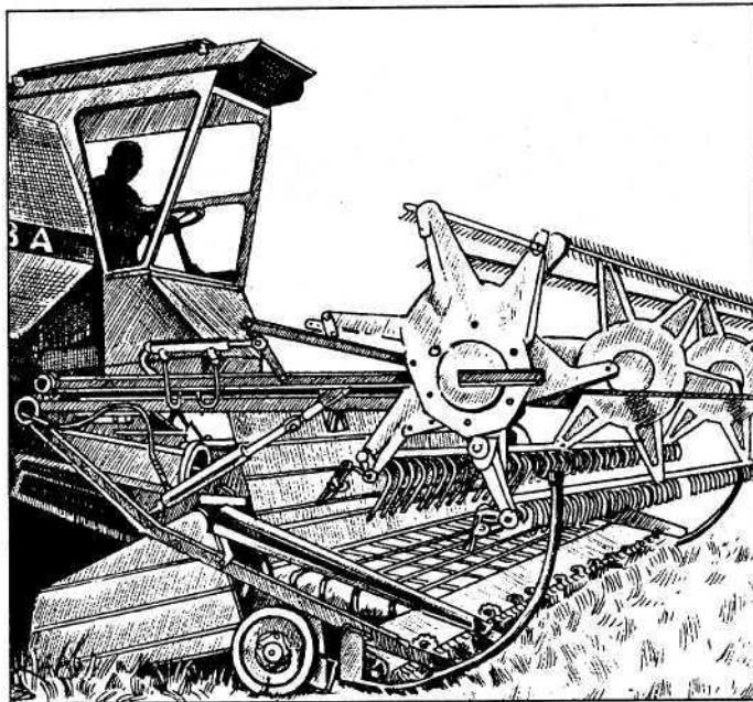
Рис. 27. Жатка самоходная зернобобовая ЖЗБ-4,2А
