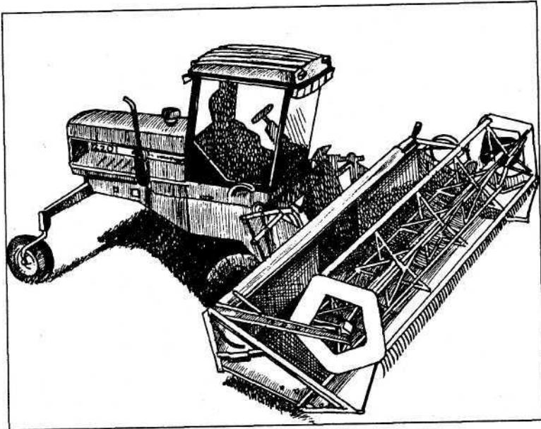
Рис. 30. Самоходная валковая жатка MF 220
