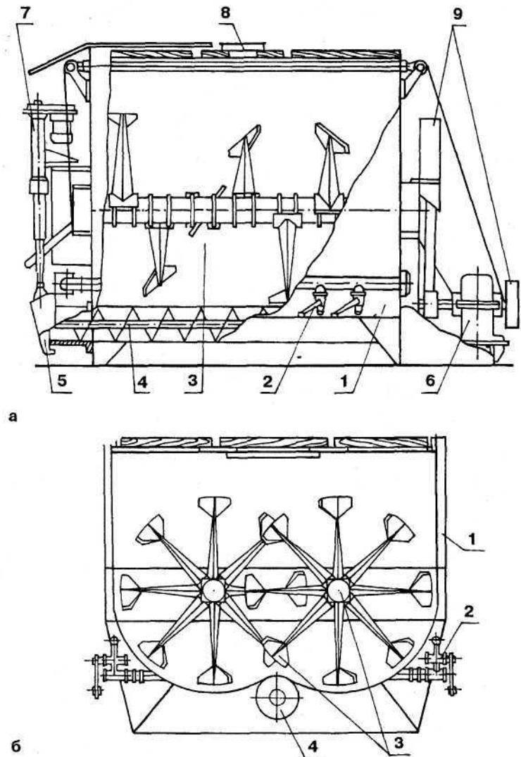
**Рис. 51. Смеситель С-12 (вид сбоку с разрезом (а) и поперечный разрез (б)):**
