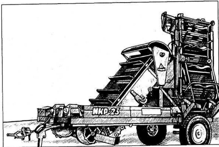
Рис. 40. Машина корнеуборочная МКР-2-3
