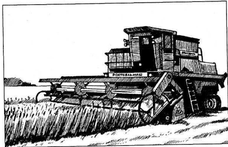
Рис. 31. Зерноуборочный комбайн «Дон-1500Б»
