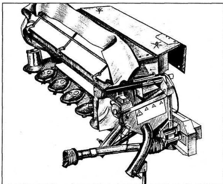
Рис. 9. Косилки ротационные «Disco», «Corto»
