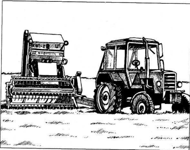
Рис. 34. Комбайн зерноуборочный КЭП-2 «Азовец-800»
