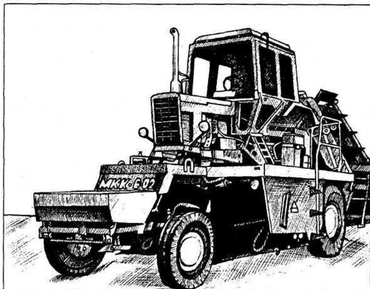
Рис. 42. Машина для уборки кормовых корнеплодов МКК-6-02
