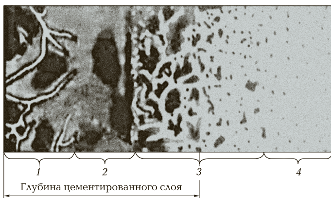
Рис. 6.13. Различные микроструктуры, образующиеся при цементации, в зависимости от глубины насыщения углеродом:
