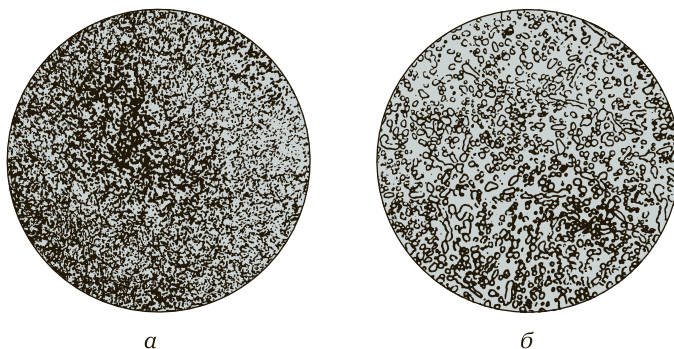
Рис. 6.5. Микроструктура стали марки 40, полученная в результате литья и ковки (а) и после нормализации (б)
